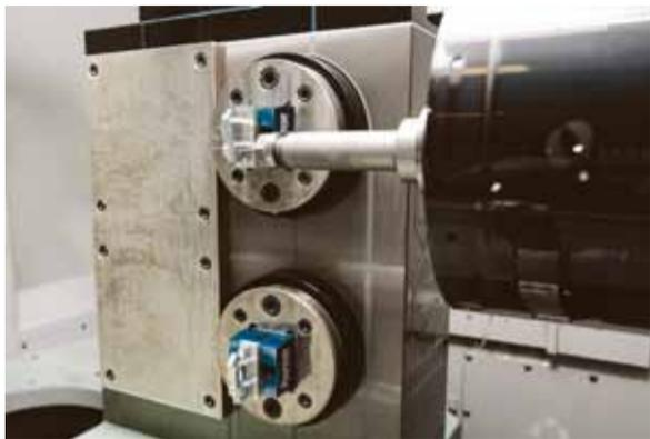
■ 结合了燕尾榫零件夹紧的这种第五轴多零件加工模块技术,使得 Campbell 工程公司能够满足医疗客户更大需求,并且应用 3+2 五轴加工,以减少加工复杂零件所需要的设置数量
