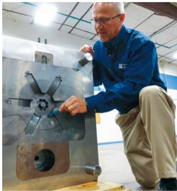
■ D1 模具和刀具产品可以满足不同行业的压铸模具加工需要。工厂负责人 Tony Dungan 展示了一个为洗衣机零件制造的模具
